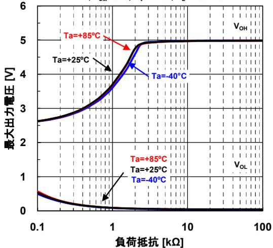
最大出力電圧 对 出力電流特性例
