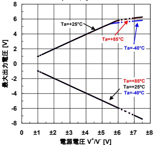
最大出力電圧 对 電源電圧特性例
